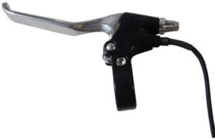
Il s'agit d'une poignée de frein classique dotée d'un contacteur électrique (ToR). Cette information booléenne logique informe le calculateur d'un freinage et donc stoppe immédiatement toute alimentation en énergie du moteur.
