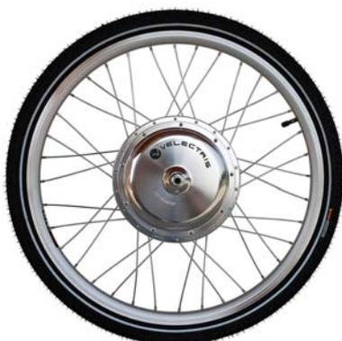
La fréquence des signaux électrique observées à l induit est égale à  $p \cdot$  vitesse de rotation mécanique du moteur.
