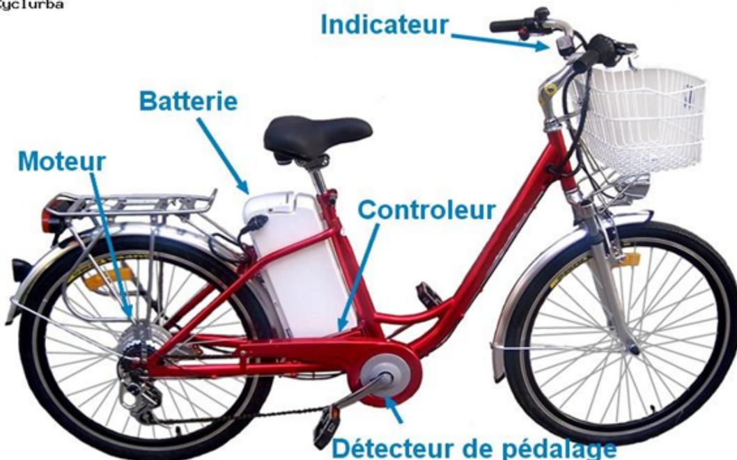
Figure 2-2 : localisation des éléments constitutifs d'une assistance électrique sur un VAE
